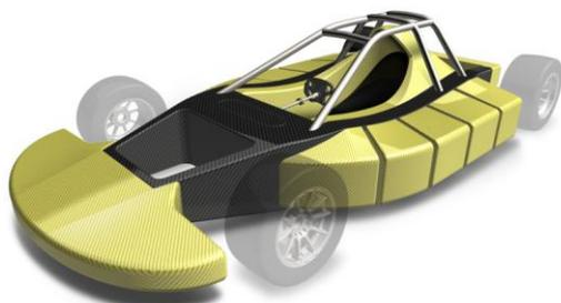
**シャシー概念図：**極めて安全性の高いレーシングカー・シャシーのアイデアを基に発展させ、「Super Sports K4」としてカーボンコンポジットモノコック、クラッシュプルストラクチャー、オーバーオール型ロールバーを備えた軽量・高剛性かつ安全な車両を製作します。
